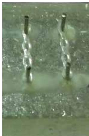
Figura 3. Muestras de cadenas elastoméricas traccionadas
