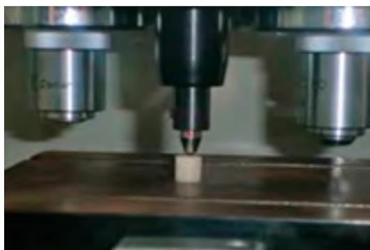
Figura 2. Medición de la dureza con el microdurómetro (ZHV Zwick Roell, Alemania)
