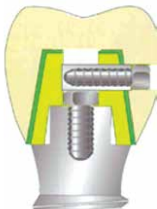
Figura 3. Combinación de prótesis cementada y atornillada.
