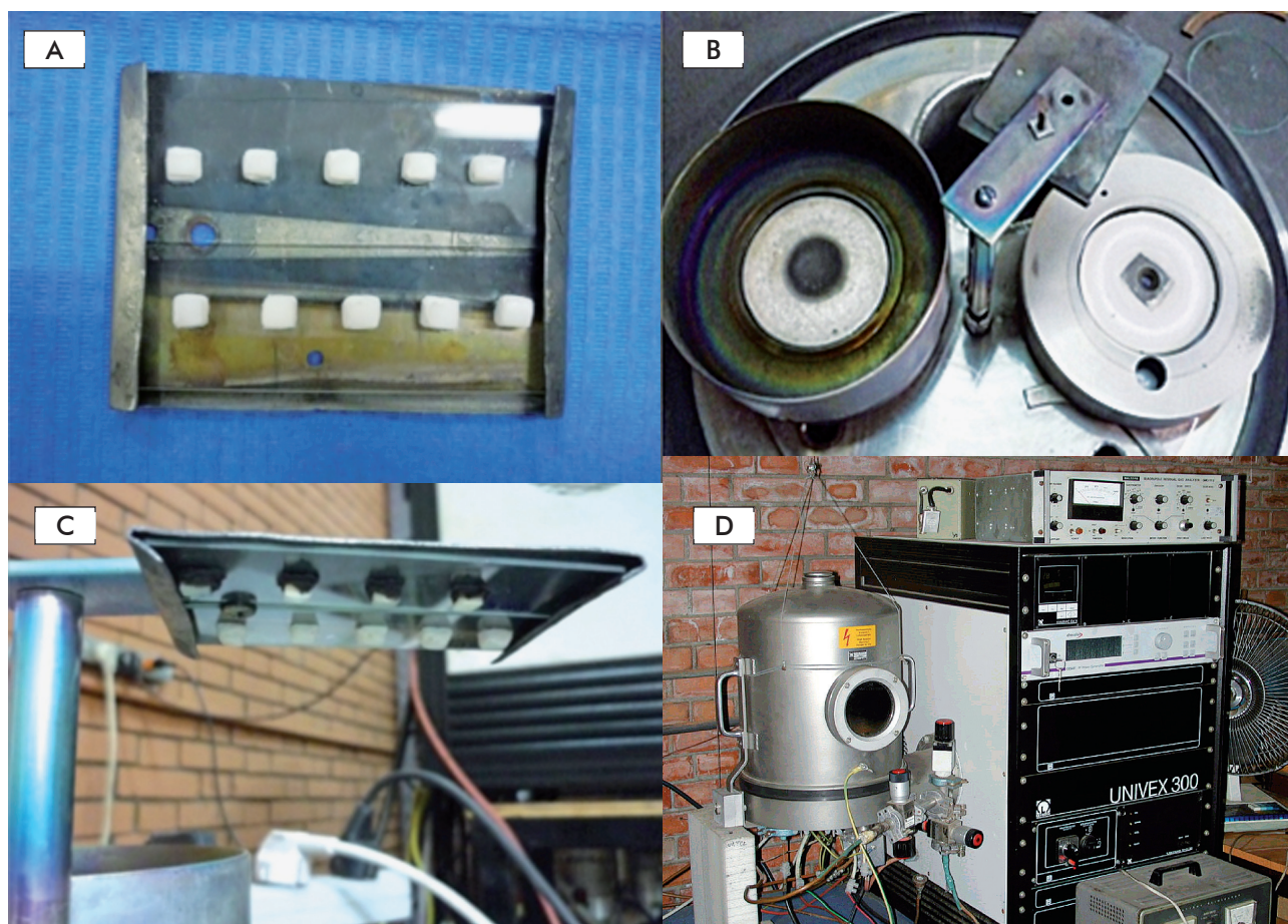
Fig. 4. Preparación de los fragmentos para la evaporación iónica. Montarlos en láminas portaobjetos (A). Interior de la cámara de vacío (B). Muestras dentarias en posición para ser recubiertas (C). Exterior de la cámara de vacío (D).
