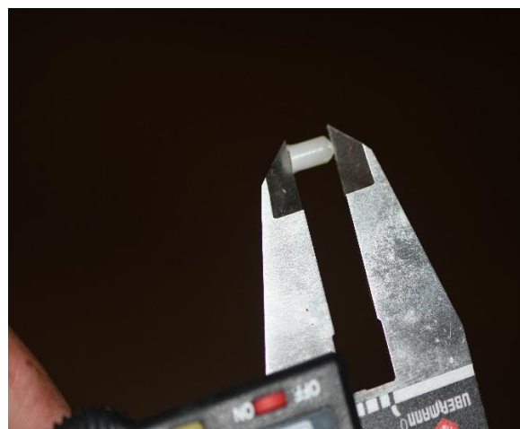
Figura 3. Medición de los cilindros de resina.
