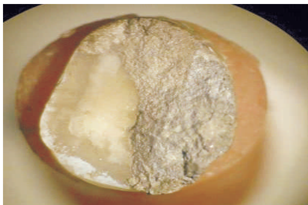
Figura 3: tipo de falla: mitad en la dentina y mitad en la amalgama
