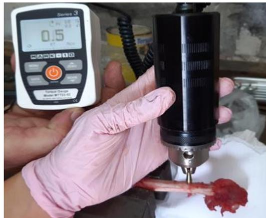
**Figura 5:** Medición del torque de remoción de los implantes
