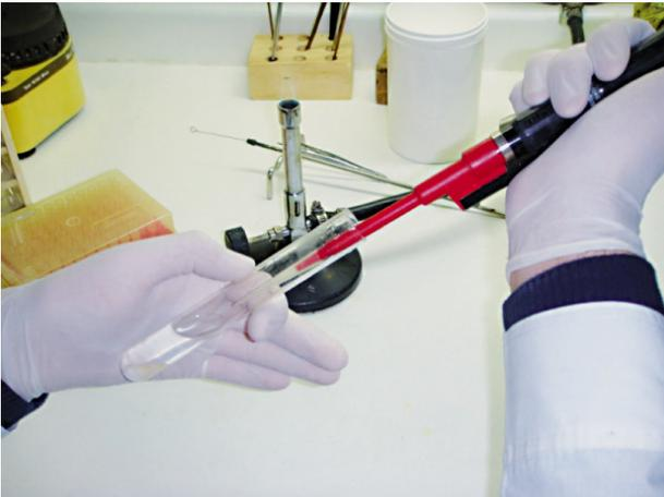
**Figura 5.** Obtención de una muestra de solvente que contiene las bacterias antes desprendidas.
