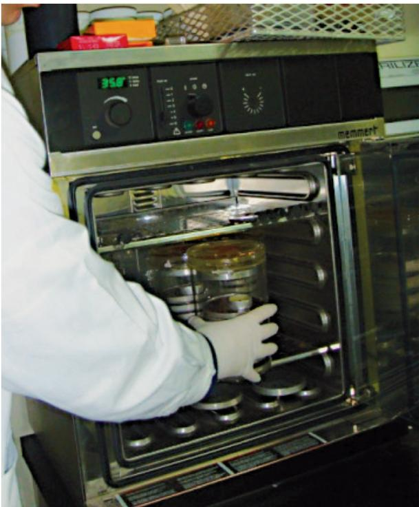
**Figura 7.** Colocación de los cultivos en el horno a una temperatura de 36 grados centígrados por 24 horas.
