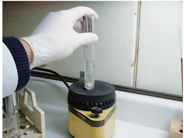
**Figura 4.** Desprendimiento de las bacterias adheridas a la superficie dentaria por medio de la agitación con Vórtex.
