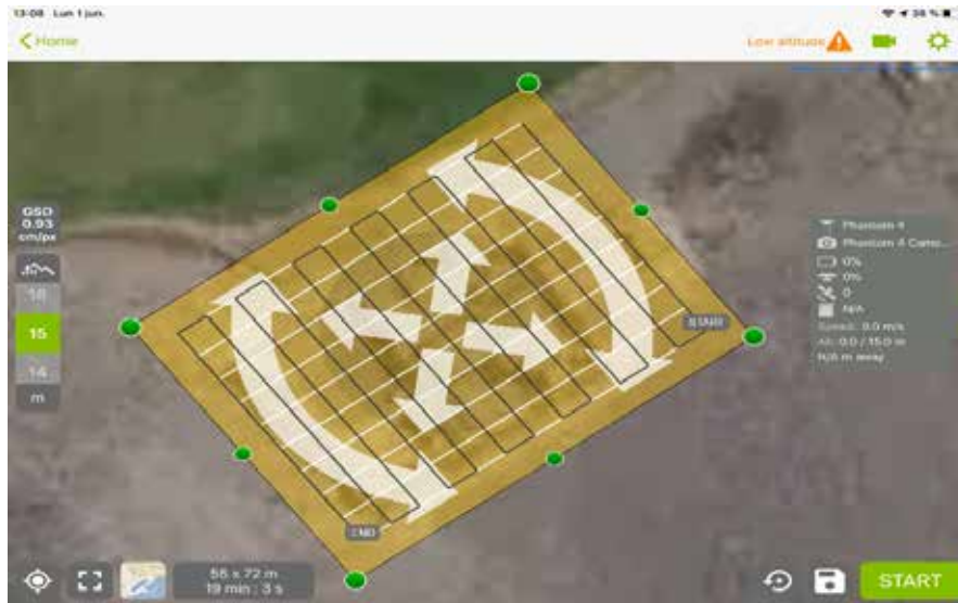
Figura 5. Planificación de vuelo Doble cuadrícula con Pix4D Captur
