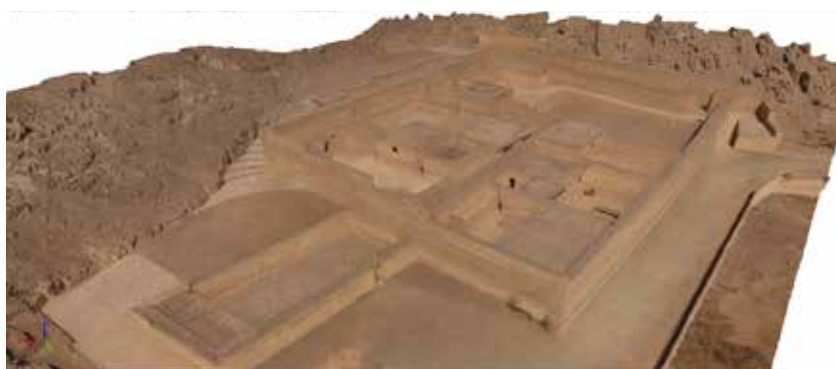
Figura 10. Malla con textura generada a partir de la nube de puntos - Captura de pantalla de Pix4D Mapper
