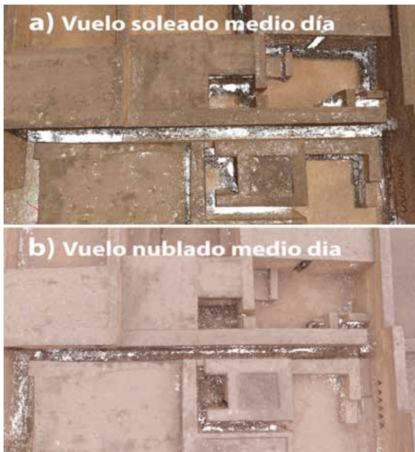
Figura 6. Comparación de calidad de la nube de puntos en función a las condiciones de luz – Las zonas blancas en las imágenes enseñan la ausencia de puntos.
