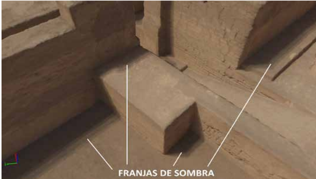
Figura 7. Problema de franjas de sombra en la textura. Modelo realizado en base a fotos capturadas por dos vuelos realizados a medio día en un lapso de solo 45min.
