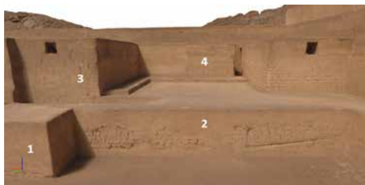
Figura 11. Nivel de calidad de visualización de texturas según distancia entre el observador y el objeto. 1. 8m: calidad insuficiente, 2. 9m: Calidad ligeramente insuficiente 3. 12m: calidad satisfactoria 4. 18m: calidad muy satisfactoria. Captura pantalla Pix4D
